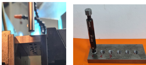
ネジ加工後の裏表バリ取り、内部のねじ山を傷つけずにバリ取りができます。
