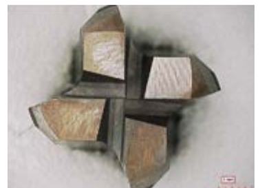
エポックDスレッドミル 64穴加工後の工具状態 Epoch D Thread Mill after threading 64 holes.
