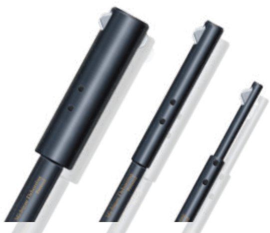
アルミニウム A5052 ミシガンデバリングツール J-1800 Φ18 Vc=15m/min N=265rpm VF=27mm/min 切込み量 1.0mm
