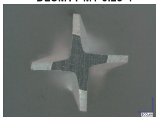
100ヶ所加工後の工具写真 DLCTMY M1-0.25-4
